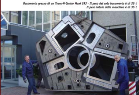
Basamento grezzo di un Trans-N-Center Maxi SR2 - Il peso del solo basamento è di 25 t. Il peso totale della macchina è di 35 t.
