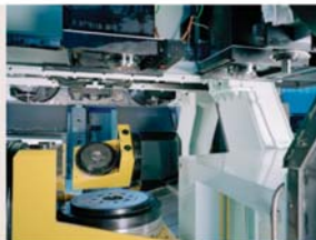
Anche della macchina Trans-N-Center è in corso la brevettazione di una versione a cinque assi. Esiste però già la Omni-Flex cinque assi dotata di due rotoblocchi e quattro mandrini di lavoro.
