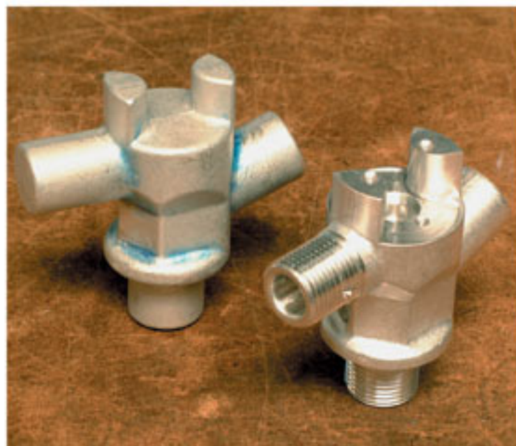
Fig. 8 - Altro esempio di pezzo lavorato sulla nuova macchina (grezzo a sinistra, finito a destra).
