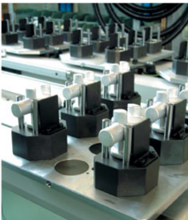
Fig. 11 - Dettaglio di pezzi pallettizzati sullo speciale sistema di caricamento automatico del quale la nuova macchina può essere dotata.
