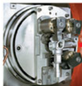
Fig. 3 - Dettaglio 3D dei due dispositivi rototiltanti per il serraggio pezzi mentre si scambiano il pezzo in lavorazione, per permettere la lavorazione della 6ª faccia.
