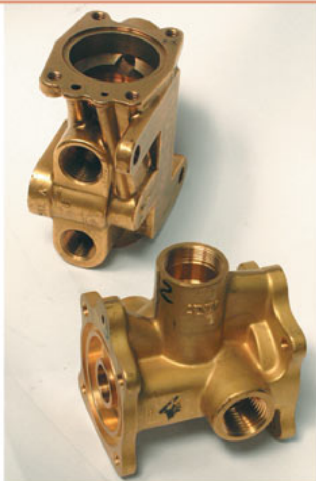
Fig. 10 - Un pezzo complesso, lavorato completamente sulla nuova macchina in un solo ciclo.
